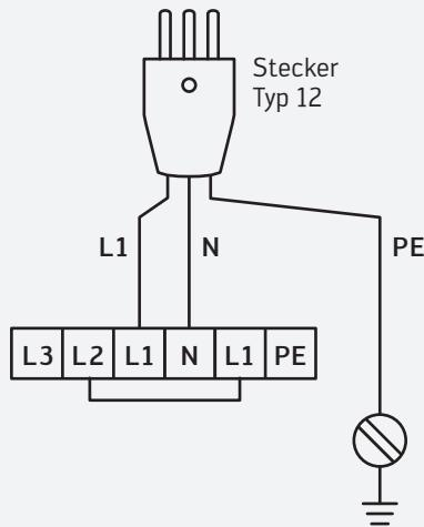
Wärmepumpe 0,5 kW
