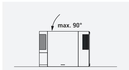
Nach jedem Transport muss der Trockner 10 Minuten ruhen, bevor er eingeschaltet werden darf.
