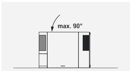
Après chaque transport, la machine doit reposer 10min avant d'être mise en marche
