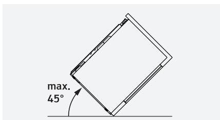
La machine peut être couchée soigneusement sur le côté gauche.
